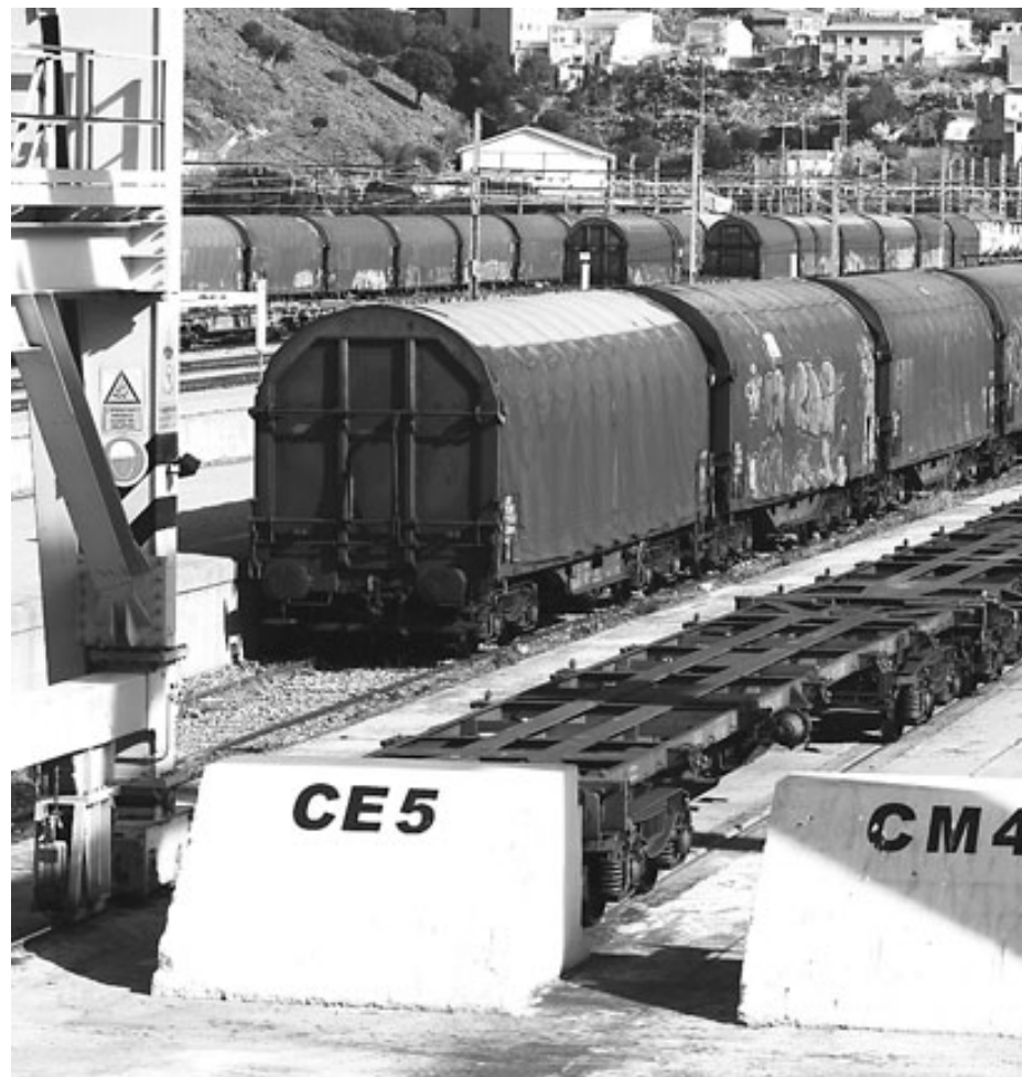
A les instal·lacions ferroviàries de Portbou es poden veure els diferents amplituds de via. A la foto en primer terme es diferencien una d'espanyola (CE5) i una de mixta (CM4). / LL. SERRAT
