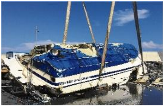
La part inferior del buc, destrossat per l'impacte.
