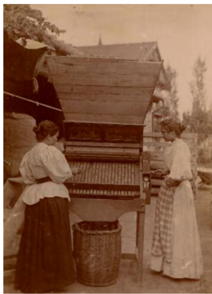
FOTO PORTADA: MÀQUINA DE COMPTAR TAPS EN EL PATI DE LA FÀBRICA DE CAN MENNA. A L'ESQUERRA, LA MARIETA MIR I A LA DRETA, LA MINGA MIR. (FOTO: AMCS/COL·LECCIÓ MONTSERRAT GENER)
