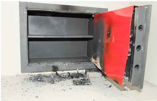
L'estat amb què va quedar una de les caixes, que en ocasions eren obertes amb bufadors. Foto: CME.
