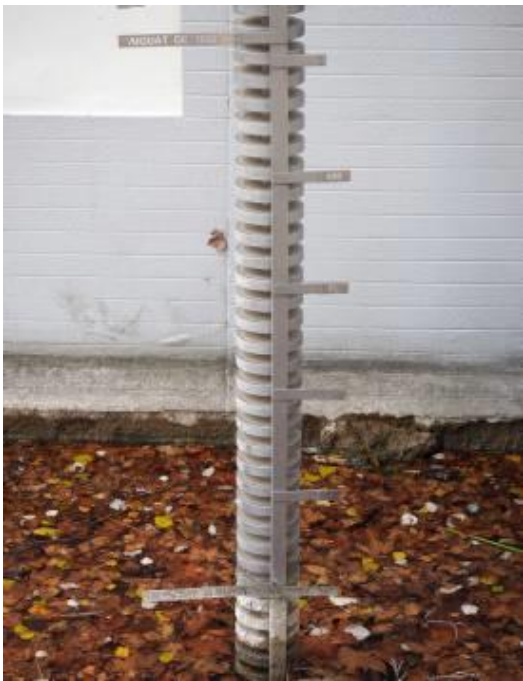
El limnítmetre de l'estany, en l'estat en que es troba en l'actualitat.
