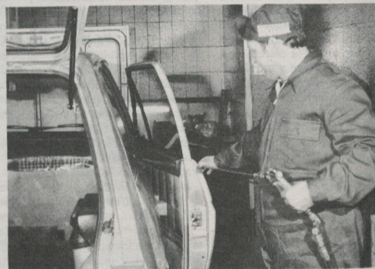
Inyección del producto Dinitrol Metallic en la puerta.
