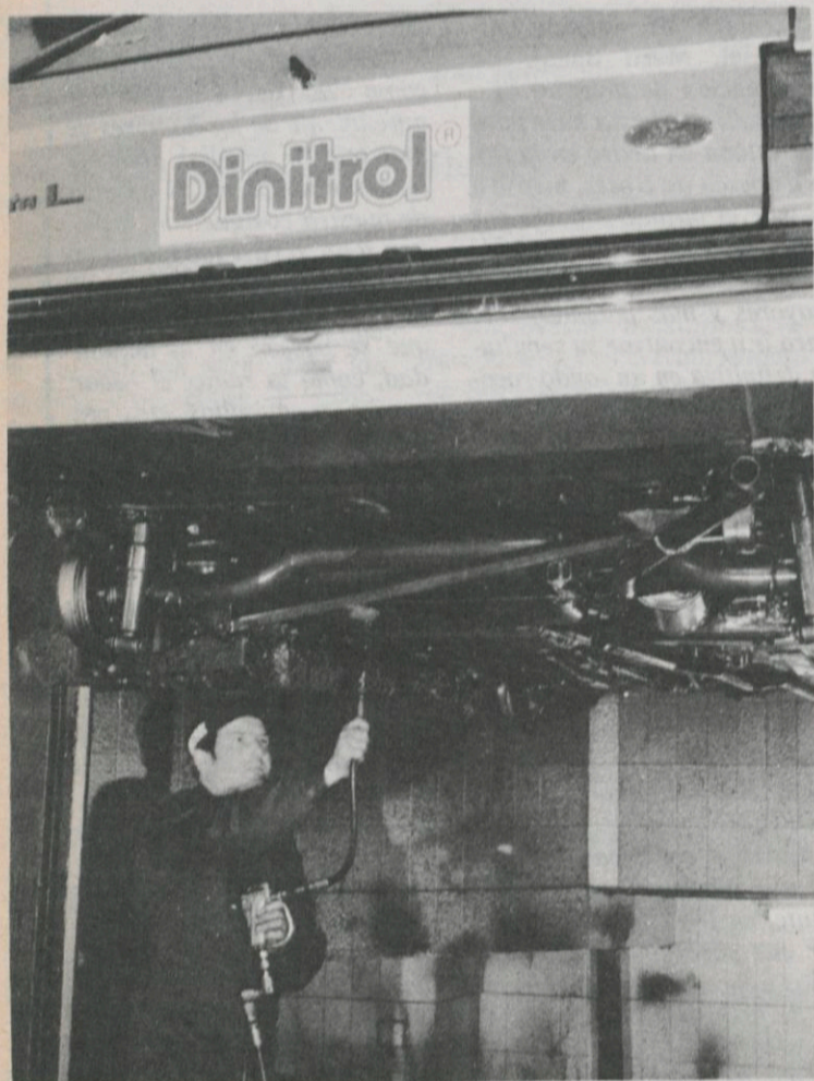
Inyección del producto Dinitrol Metallic en el faldón del chasis.
