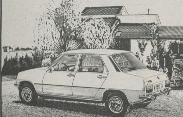
Motor Renault 1.037 cm<sup>3</sup>. Tracción delantera. Suspensión por barras de torsión. Cuatro puertas.
