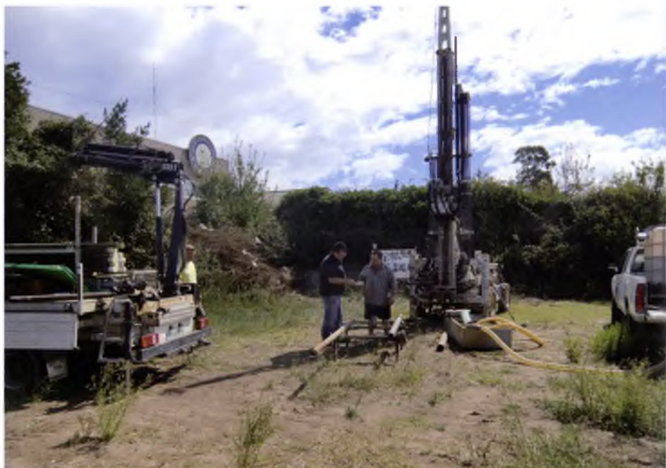
Treballs de realització del sondeig mecànic fet a l'Horta Vella per conèixer l'estratigrafia del sector al sud d'Empòrion.
