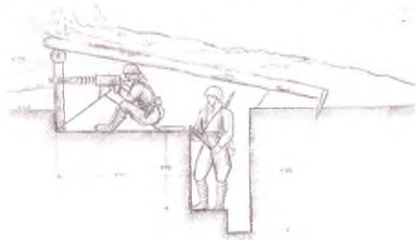
Perfil de trinxera con blindaje ligero.
