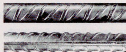
AEH-500. Corrugas de la misma inclinación en un sector y en el otro sector con dos inclinaciones. (Cortesía del Instituto Eduardo Torroja).
