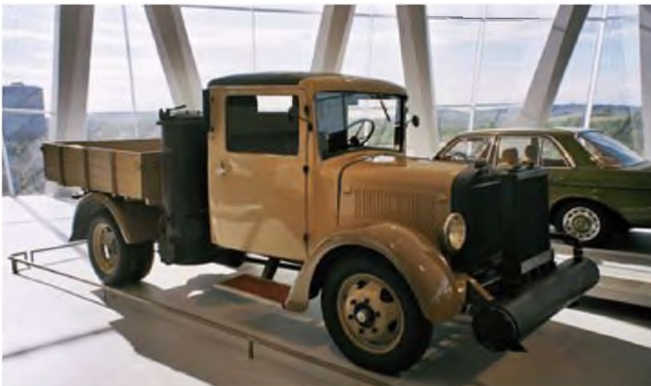
Camió Mercedes-Benz L 1500 (1937) equipat amb un gasogen. Museu Mercedes-Benz. Stuttgart (Alemanya) (Fotografia de l'autor).
