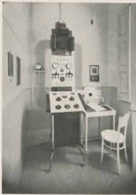
Cabina eléctrica per a l'aplicació de Raigs X.
