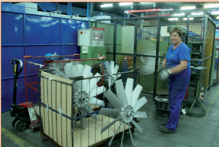
El rotor dels ventiladors es prova abans de muntar-los
