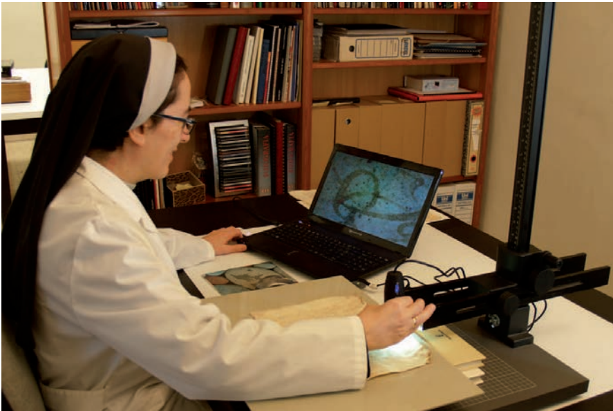
Examinant amb el microscopi l'estat de les tintes
