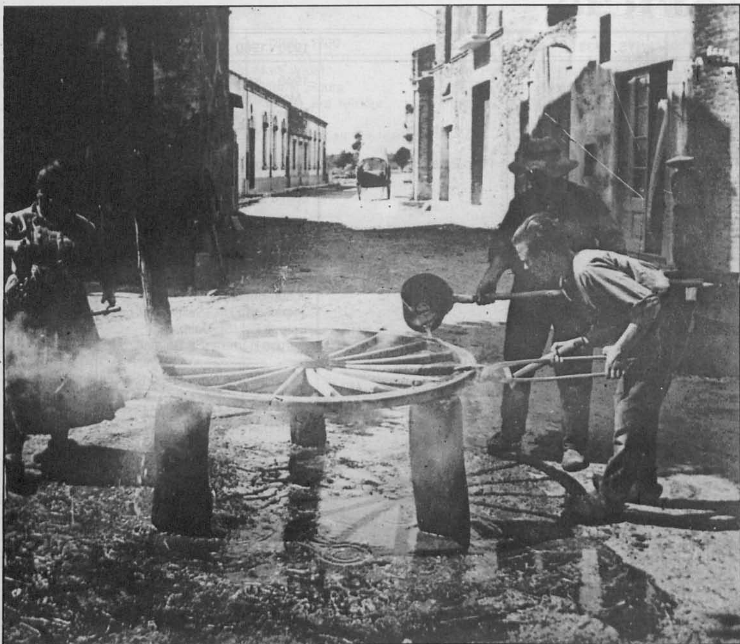
Vilobí. Anys 20. Plaça Nova. Per ferrar les rodes, calia la col.laboració del ferrer i el carreter.
