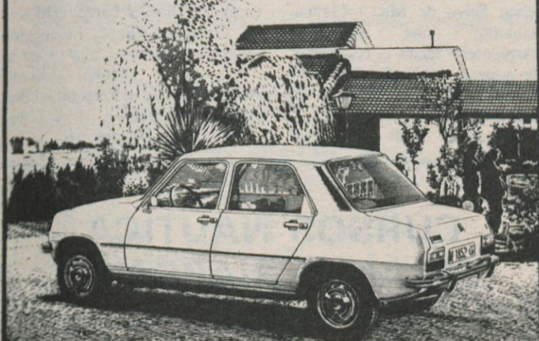
Motor Renault 1.037 cm 3 Tracción delantera. Suspensión por barras de torsión. Cuatro puertas.
