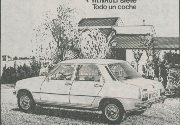
Motor Renault 1.037 cm 3 Tracción delantera. Suspensión por barras de torsión. Cuatro puertas.
