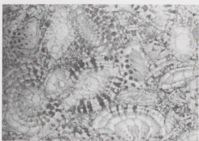
Fig.8. Aspecte microscòpic de la calcària de Girona procedent de les pedreres històriques: a) varietat blanca, b) varietat blava (MOP, x10). Pot observar-s'hi una major grandària dels nummulits i l'escassetat de fase d'unió entre si. La varietat blava també presenta un aspecte més fosc, a causa d'una major presència de components opacs.
