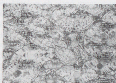
Fig.10. Calcària de Girona procedent del monument, del tipus pedreres històriques, varietat blava: a) sense analitzador, b) amb analitzador (MOP, x10). Pot observar-s'hi el grau d'empaquetament dels nummulits, amb processos de dissolució per pressió i desenvolupament de microestilolits.
