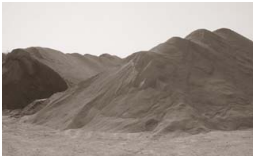
Zona d'aplec de sorra. En primer terme, sorra provinent del reciclatge de formigó, i en segon terme, de materials ceràmics.
