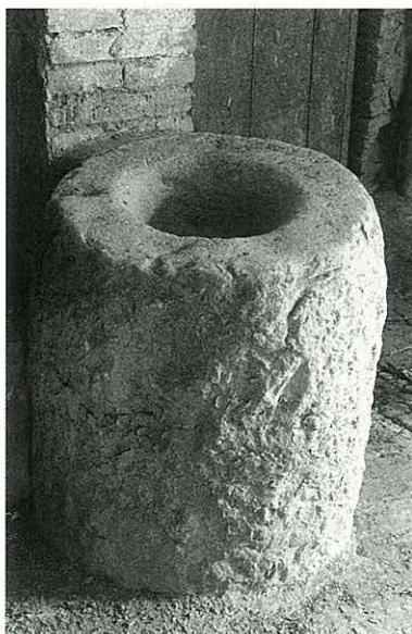
Morter de moldre vernís probablement molt semblant al que es descriu en l'apèndix. Terrisseria Salamó. La Bisbal.
