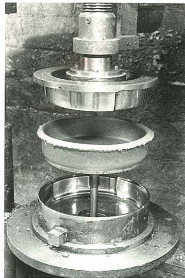
Presma de fer cassoles i sops. Refrafo. Breda
