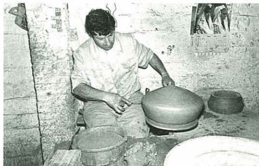
Oller clavant la botxa per fer un sop en el rodell del torn. Refrafoç. Breda.
