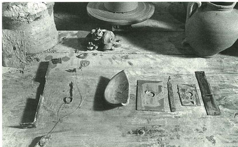
Eines que complementen el treball del terrisser, d'esquerra a dreta: ferrussa, gansalla, naf, escabeta i cuirol.
