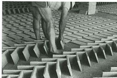
Rajoler realitzant una operació relacionada amb el l'assecatge de l'obra. Rajoleria de Regencós senyor Ferrer.
