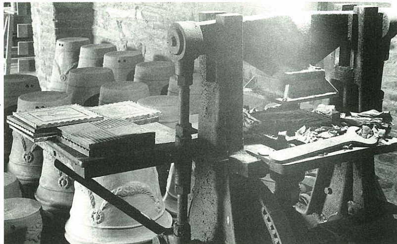
Prensa de fer rajoles de principi de segle. Can Marcó.
