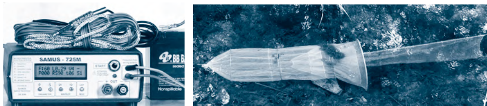
Figura 4. Equipament de mostreig utilitzat: a l'esquerra, equip portàtil de pesca elèctrica (SAMUS); a la dreta, bar- bol de malla petita
