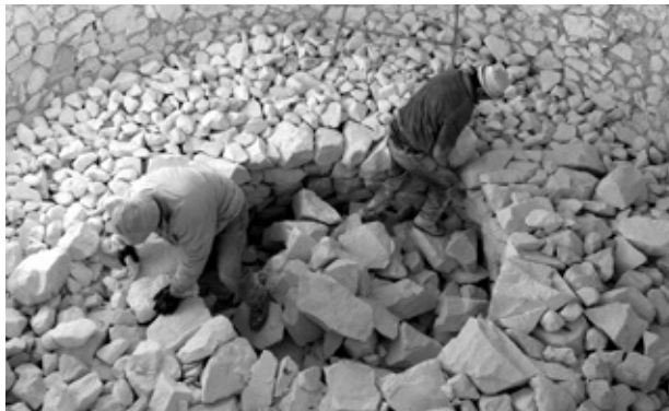
Preparació d'una fornada de calç a Aldea Caleras de la Sierra - Morón de la Frontera (Sevilla) l'any 2005, en una zona amb forns de calç en actiu. Autor: Manuel Gil Ortiz. Museo de la Cal (Morón de la Frontera, Andalusia).
