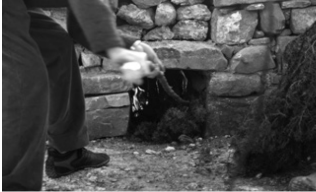
Introduint feixines dins d'un forn de calç l'any 2010 al Mas de Noguera (Caudiel), a la comarca de l'Alt Palància (País Valencià). Font: Arxiu del Museu Valencià d'Etnologia.
