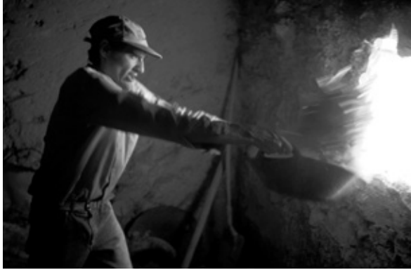
Treballador d'un forn de calç en actiu d'Andalusia en l'actualitat, controlant la temperatura del forn. Autor: Manuel Gil Ortiz. Museo de la Cal (Morón de la Frontera, Andalusia).
