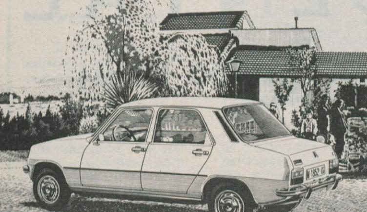
Motor Renault 1.037 cm<sup>3</sup>. Tracción delantera. Suspensión por barras de torsión. Cuatro puertas.
